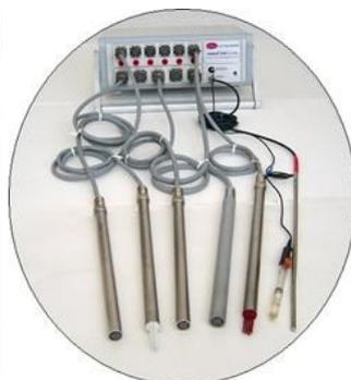
多電極複合センサーは複数の電極が無抵抗電流計を介して接続されており、金属表面の局部的挙動をそれぞれの電極が担うことで、金属表面における局部的な腐食現象を含めた金属表面全体の挙動をリアルタイムに測定できるという優れた測定装置です。
